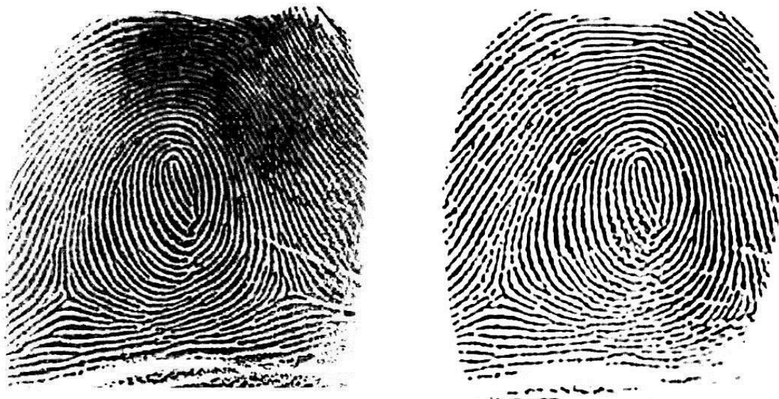
圖 3-2：油墨捺印及活體掃描設備捺印指紋之比較圖。左圖為油墨捺印指紋，捺印過程指紋上半部因磨擦出現模糊不清的狀況；右圖為活體掃描設備捺印指紋，經電腦自動修正滑動紋線，捺印結果指紋上半部能保持清晰的指紋紋線。
