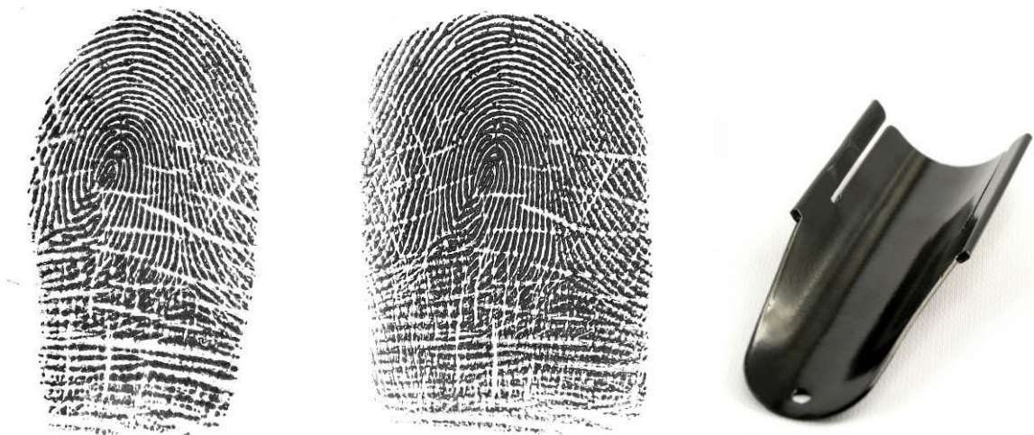
圖 2-2-3：有無使用凹形夾紙器的比較。左圖為指紋平面印的結果，右圖為凹形夾紙器外觀，中圖為使用凹形夾紙器所捺印的指紋；比較左圖與中圖可以發現，使用凹形夾紙器
