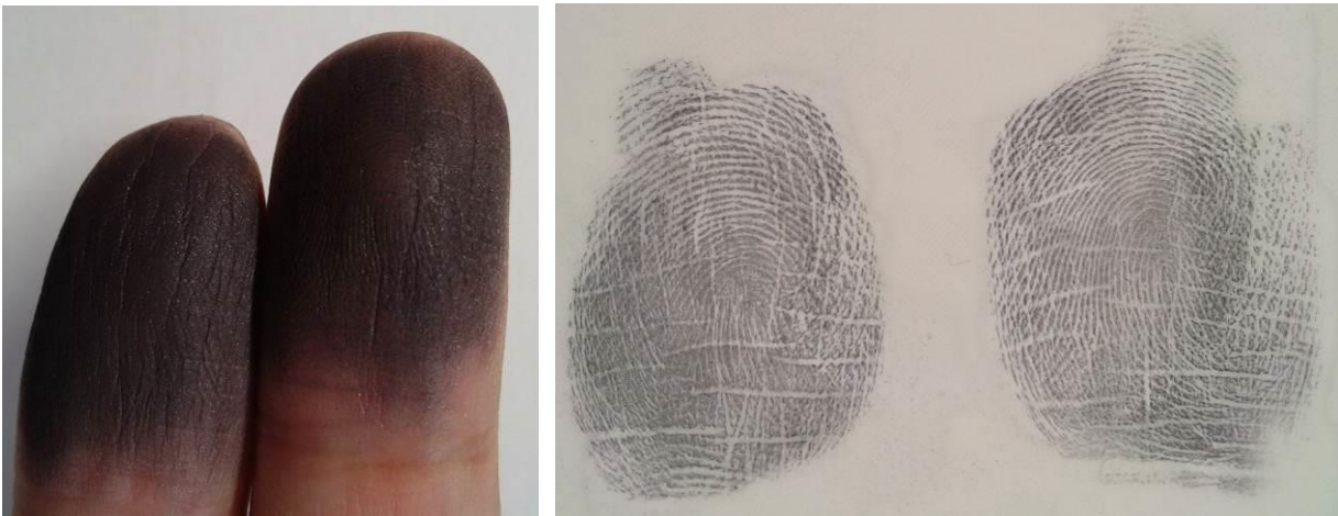
圖 2-2-5：測試粉末法採取手指指紋的過程與結果。左圖以碳粉刷掃指紋隱沒不清的手指，所有凹凸表面都會沾附粉末；右圖為膠片黏取指紋的結果，尚能清楚辨識紋線與特徵點。
